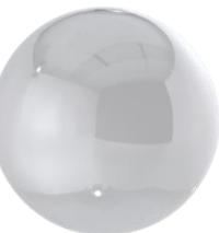
**Dijamant** - Dijamantske sfere su idealne za merenje veoma tvrdih ili visoko abrazivnih obradaka, kao i za skeniranje radnih komada gde je samo jedna tačka sfere uglavnom u kontaktu sa radnim predmetom (npr. merenja (skeniranja) na rotacionom stolu).
