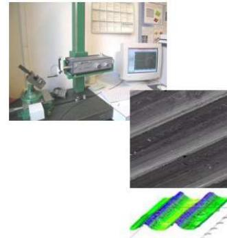
Primenom konvencionalnih parametara hrapavosti površine možemo okarakterisati kvalitet površine pomoću nekoliko drugih parametara hrapavosti i neravnina, a na osnovu skenirane površine možemo definisati još nekoliko parametara 3D hrapavosti površine. Ovi parametri su dobri za upoređivanje ili klasifikaciju površina, ali generalno ne možemo da ih koristimo u fazi projektovanja, jer veza između parametara hrapavosti površine i parametara proizvodnog procesa nije poznata do detalja.
