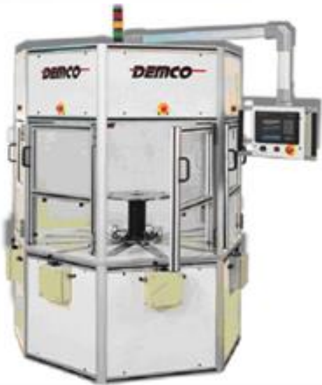
Аутомат за монтажу (DEMCO) а) Основни модул б) Манипулатор као надградни модул
