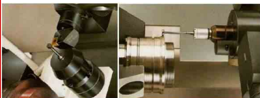
Merenje alata, merni senzor u radnom prostoru mašine
