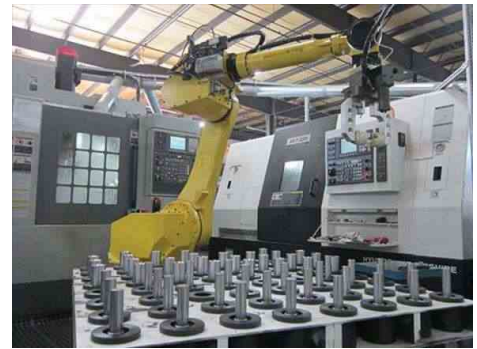
Primer instalacije i primene industrijskog robota zglobne konfiguracije kao komponente FTs
