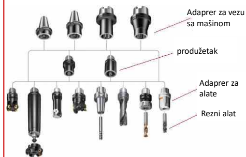
Primer različitih konstrukcionih rešenja načina stezanja modularnih alata koji se koriste na mašinama kao komponentama FTs
