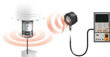
Optički sistem prenosa signala IC zracima
