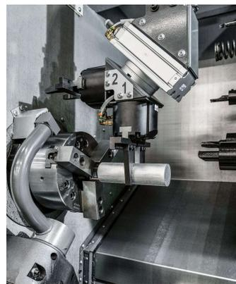
Primer stezanja u glavno vreteno šipkastig pripremljivača kod automatske manipulacije primenom automatskih dodavača, robota.
