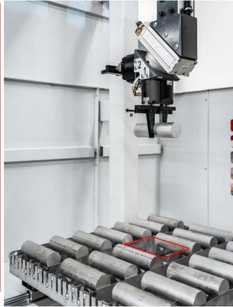
Primer ciklusa zamene radnog predmeta sa 2 položaja zamene predmeta obrade u okviru komponenti FTs
