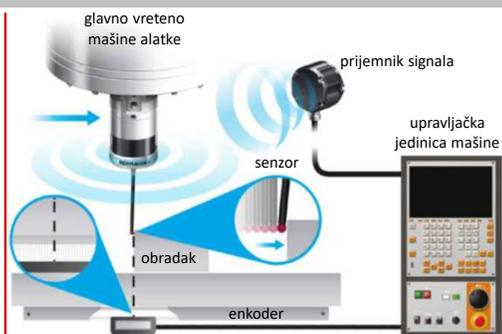
Senzor na mašini se aktivira na dodir jer koristi prekidač koji se aktivira nakon kontakta između mernog pipka senzora i predmeta koji se meri. Kada se aktivira, senzor signalizira upravljačkoj jedinici preko interfejsa i kontrolera (skoro istovremeno) mašina automatski očitava poziciju senzora preko svojih enkodera (sistem za povratne informacije).
