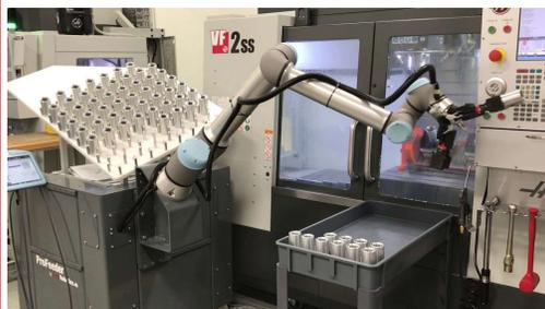
Primer ciklusa zamene radnog predmeta sa 3 položaja zamene predmeta obrade u okviru komponenti FTs
