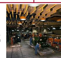
Volvo 1973 koristi 280 računarom kontrolisanih AVV u okviru automatizovane konvejerske linije za montažu automobila
