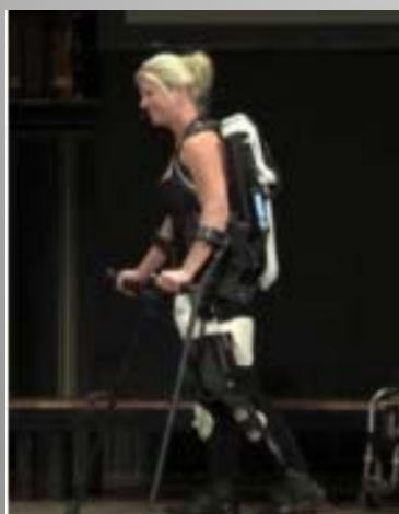
Exoskeleton dobijem pomoću FDM omogućava paralisanoj osobi da ponovo hoda
