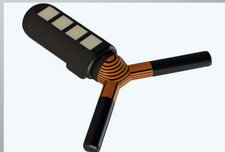
Ingestivni, samo-napajajući uređaj koji osatje u stomaku mescima iispušta diskretne doze lekova kod pacijenata koji zahtevaju dugotrajnu medikamentaciju
