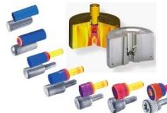
**Indirektne metode** određivanja kontaktnog trenja praćenjem određenih geometrijskih veličina uzorka u uslovima podeljenog tečenja materijala (*divided flow tests*).
