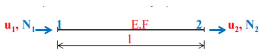
$$\begin{bmatrix} N_1 \\ N_2 \end{bmatrix} = \frac{EF}{l} \begin{bmatrix} 1 & -1 \\ -1 & 1 \end{bmatrix} \begin{bmatrix} u_1 \\ u_2 \end{bmatrix}$$
