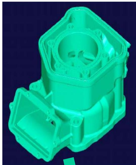
3D digitalizacija izrađenog dela (primenom CT-a)
