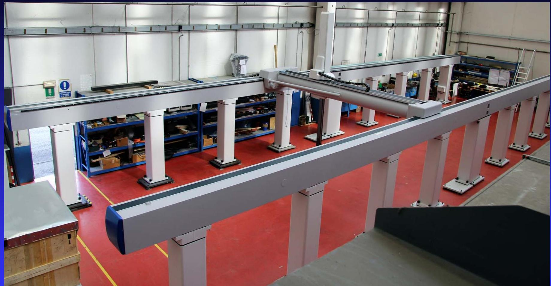
Kod svih tipova noseće strukture KMM, osim mosne, se javlja kombinacija pokretnog i nepokretnog mernog stola.
