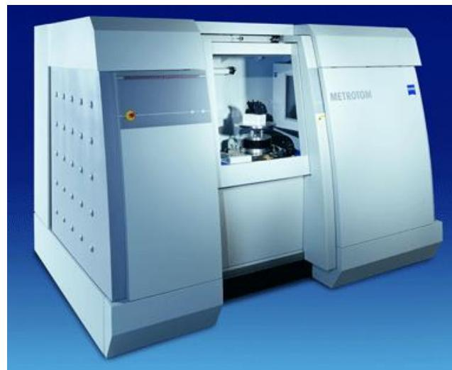
**Procedura:** Nakon što se izvrši skeniranje i dobiju se CT slojevi, vrši se rekonstrukcija kontura površina koje su ispresecane u CT slojevima, za šta se koriste softveri sa rutinama za automatizovano pronalaženje ivica, tj. **segmentaciju**.
