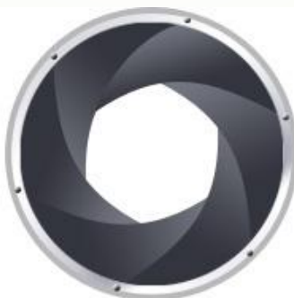
SREDNJI OTVOR BLENDE (srednja količina svetlosti) f/8
