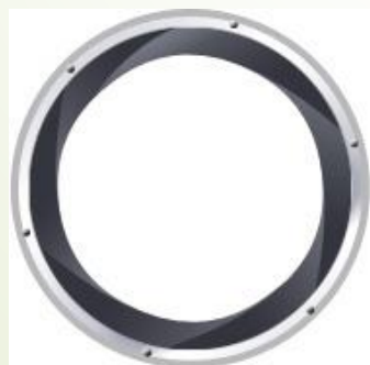
VELIK OTVOR BLENDE (ulazi mnogo svetlosti) f/2
