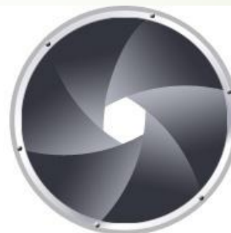
MALI OTVOR BLENDE (ulazi malo svetlosti) f/22
