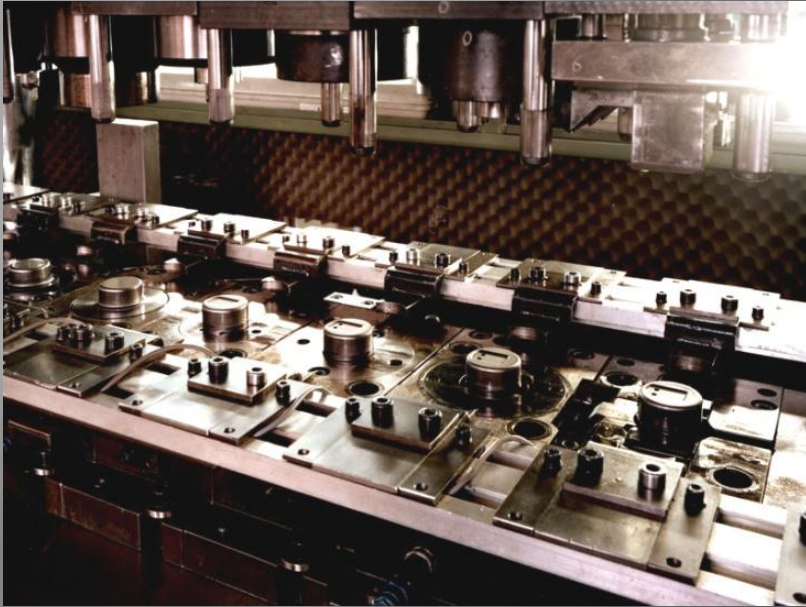
Slika 4.75 Alati višepozicione prese za izradu kućišta manometra, Wanzke [78]
