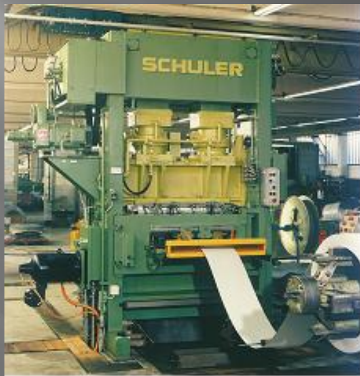
Slika 4.32 Linija za perforiranje lima po celoj širini trake, Schuler [10]
