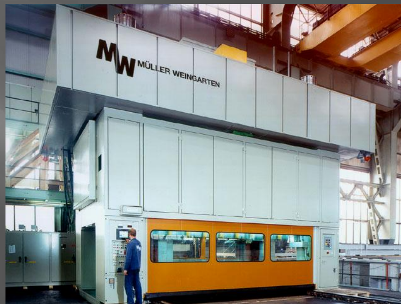
Slika 4.81 Krivajna presa za oblikovanje višepozicionim alatom, Müller Weingarten [15, 58]
