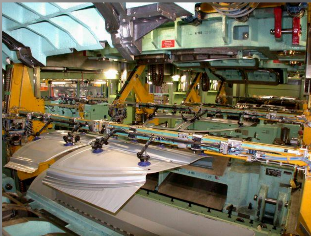
Slika 4.83 Radni prostor kompaktne transfer prese, Müller Weingarten [15, 58]
