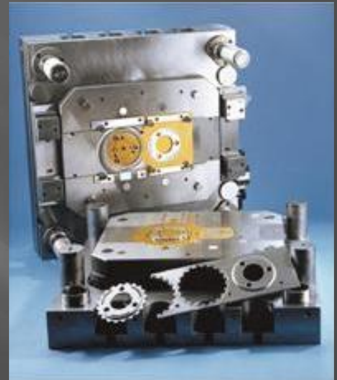
Slika 4.13 Dvopozicioni alat za FRP, Feintool [66]
