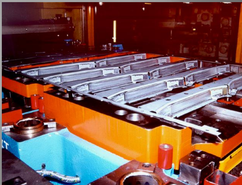
Slika 4.80 Oblikovanje lima višepozicionim alatom [15, 58]
