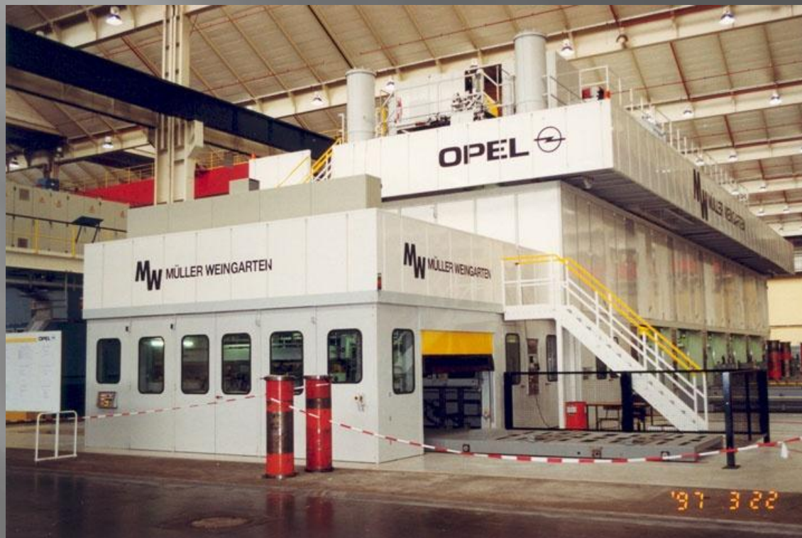
Slika 4.85 Izgled velike transfer prese, Müller Weingarten [14, 58]
