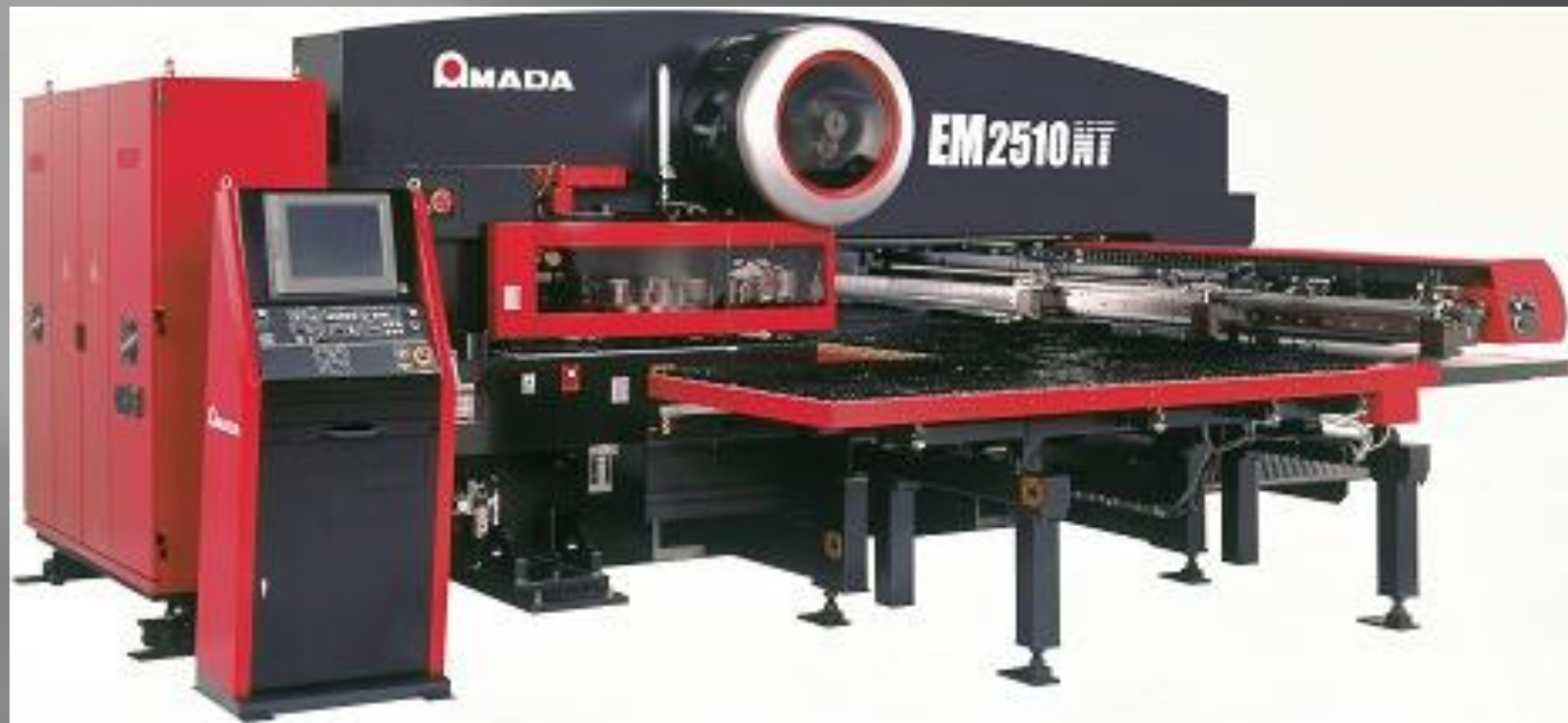
Slika 4.38 Mašina za seckanje, Amada EM2510NT [68]
