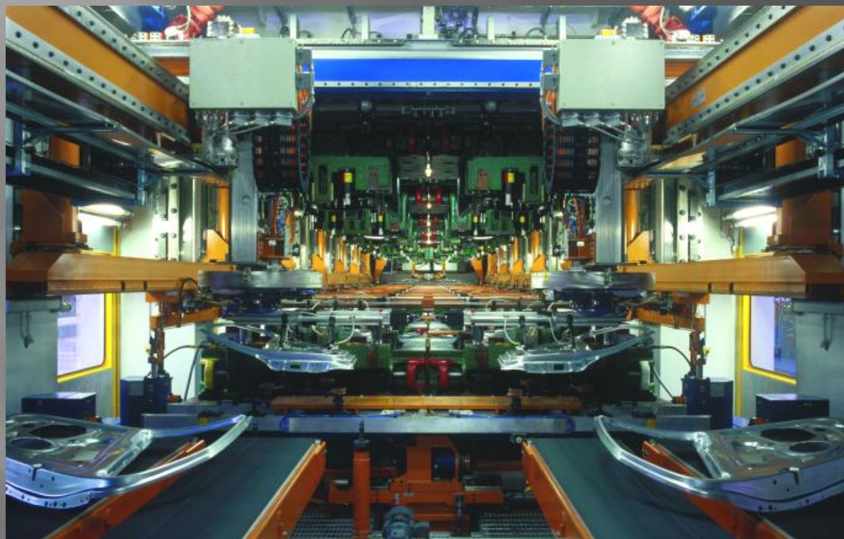
Slika 4.86 Radni prostor velike transfer prese sa poprečnim hvataljkama [58]
