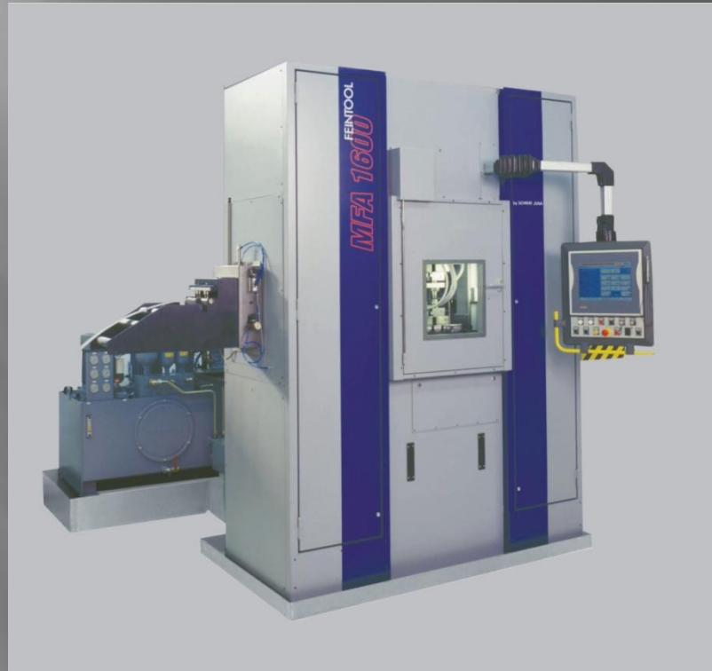
Slika 4.11 Mehanička presa za FRP, Feintool MFA 1600 [66]
