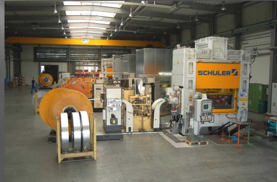
Slika 4.28 Brzohoda presa za izradu dinamo limova, Schuler SAL 200 [59]
