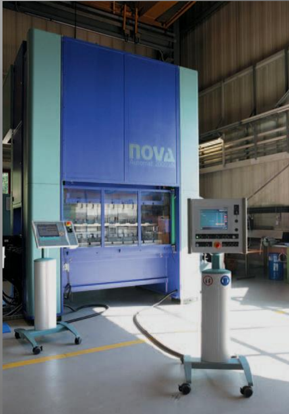
Slika 4.3 Ekscentarska presa sa višepozicionom alatima, Beutler , tip NAD-3000 [55, 64], a) presa, b) kontrolna tabla, c) servo pogon
