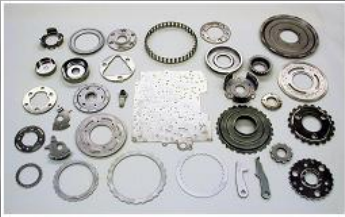
Slika 4.5 Delovi automatskog menjača automobila izrađeni FRP tehnologijom, Feintool [48, 66]
