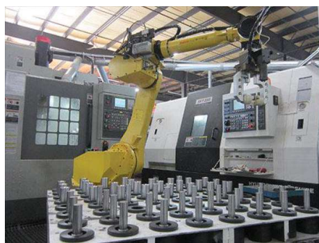
Primer instalacije i primene industrijskog robota zglobne konfiguracije kao komponente FTs
