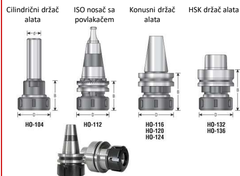
Primer različitih tipova držača alata za monolitne alate koji se koriste u komponentama FTs
