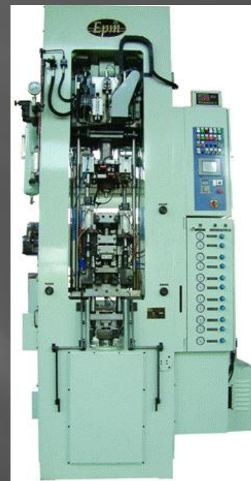
Slika 7.4 Mehanička presa za presovanje praha pomoću alata sa više gonjenih ploča [74] a) kinematska šema mašine: 1 – motor, 2 – kaišni prenosnik, 3 – spojnica sa kočnicom, 4 – zamajac, 5 – donji adapter, 6 – alat, 7, 8 – poluga, 9 – krivajna poluga, 10, 11, 12 – poluge, 13 – gornji adapter; b) izgled prese EPM-G(C35-G)SERIES
