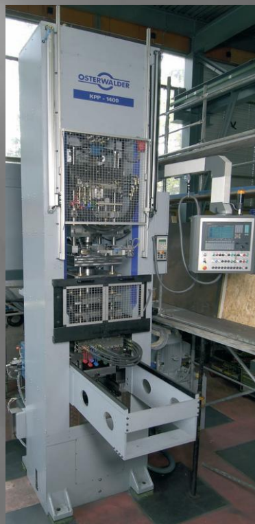
Slika 7.5 Mehaničko-hidraulična presa za presovanje metalnog praha, Osterwalder tip KPP [73] a) pogonski sistem prese, b) izgled prese
