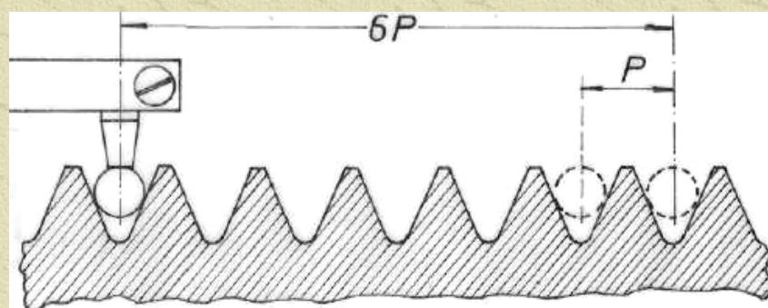
Merni pipak se postavlja i učvršćuje na pinolu maštine, a kuglica se postavlja u medjuprofil i navoja, tako da se naslanja na oba boka profila
