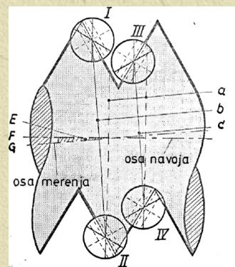
Druge očitavane izvršićemo kada se končanica, zbog pomeranja klizača u pravcu upravnog na osu radnog predmeta, poklopi sa suprotnim bokom profila. Merenjem srednjeg prečnika za levi i desni bok medjuprofila (b) i (c) i izračunavanjem aritmetičke sredine izmerenih vrednosti, neutralisaće se greška merenja zbog nepoklapanja ose merenja (G) sa osom radnog predmeta (F).
