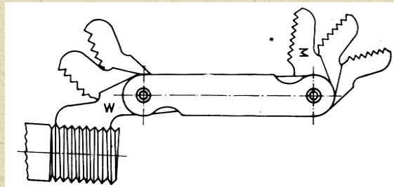
To je komplet češljeva, sa jedne strane za metrički, a s druge za Whitworth-ov navoj. Na svakom je upisana veličina koraka. Prislanjanjem uz radni predmet i upoređivanjem, možemo doći do zaključka da li je korak predmeta ispravan i koliki je.
