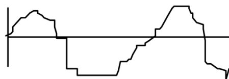
Slika 1.6: Profil a) površine sa izraženim vrhovima/dolinama ( R_{ku} = 10 ); b) sporo varirajuće površine ( R_{ku} = 1.5 )
