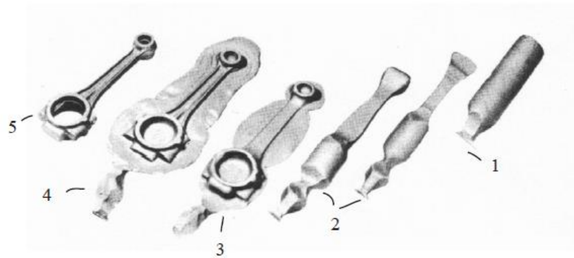
Slika 5.17 – Faze kovanja klipnjače
