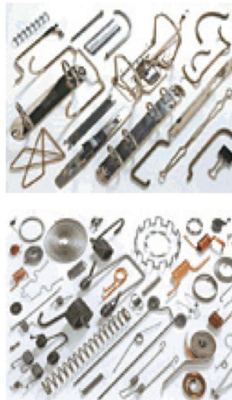
Sitni delovi od žice i uske trake izrađuju se savijanjem na specijalnim automatskim mašinama koje imaju više radnih pozicija. Postupak oblikovanja je višefazni, alati su postavljeni radikalno u odnosu na mašinu.
