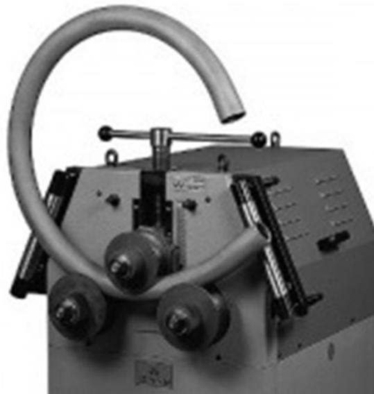
Profil različitog poprečnog preseka mogu se kružno savijati na mašinama sa tri valjka, pri čemu su ti valjci relativno male dužine. Profil valjaka treba da bude prilagođen profilu polaznog materijala.
