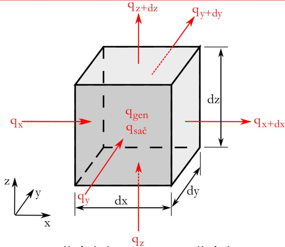
$$\left( \begin{array}{l} \text{energija koja} \\ \text{ulazi u kontrolnu} \\ \text{zapreminu} \end{array} \right) + \left( \begin{array}{l} \text{energija koja je} \\ \text{generisana unutar} \\ \text{kontrolne zapremine} \end{array} \right) - \left( \begin{array}{l} \text{energija koja} \\ \text{izlazi iz kontrolne} \\ \text{zapremine} \end{array} \right) = \left( \begin{array}{l} \text{energija} \\ \text{sačuvana unutar} \\ \text{kontrolne zapremine} \end{array} \right)$$
