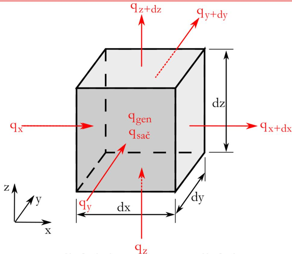
$$\left( \begin{array}{c} \text{energija koja} \\ \text{ulazi u kontrolnu} \\ \text{zapreminu} \end{array} \right) + \left( \begin{array}{c} \text{energija koja je} \\ \text{generisana unutar} \\ \text{kontrolne zapremine} \end{array} \right) - \left( \begin{array}{c} \text{energija koja} \\ \text{izlazi iz kontrolne} \\ \text{zapremine} \end{array} \right) = \left( \begin{array}{c} \text{energija} \\ \text{sačuvana unutar} \\ \text{kontrolne zapremine} \end{array} \right)$$
